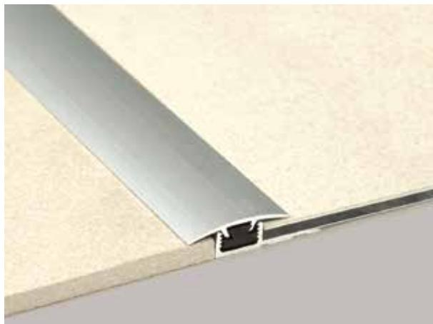
Profilo di giunzione brevettato per pavimenti LVT/SPC complanari. L'ingegnoso sistema con clip in Resinil consente, ruotando, di compensare anche piccole differenze di livello sino a 1,5 mm. Il profilo permette inoltre di raccordare pavimenti di spessore da 4 a 6 mm. Funge da giunto di dilatazione grazie alla cavità interna che consente un movimento dei pavimenti sottostanti di  $\pm$  2 mm.
